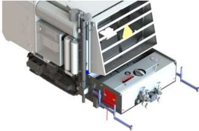
Sistema de emulsão montada na traseira da máquina, com dosagem eletrônica.
