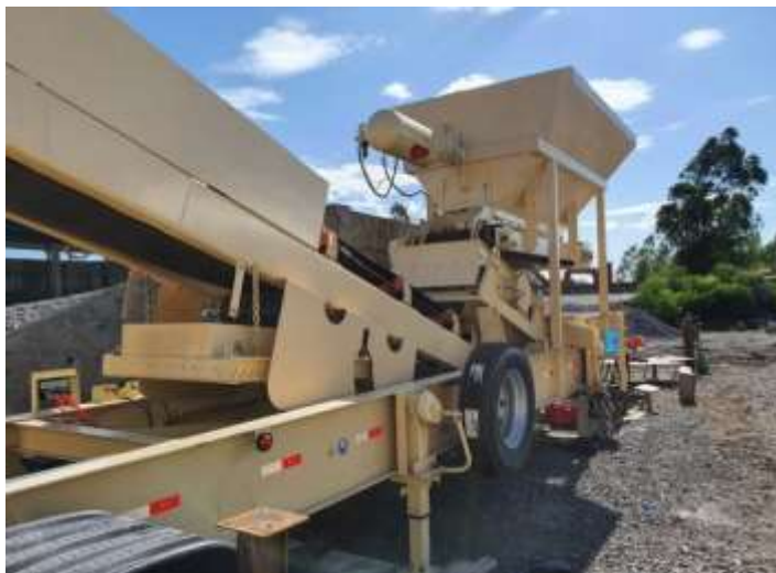
Módulo móvel com silo, peneira vibratória, pesagem e correia transportadora apta a receber até 30% de RAP
