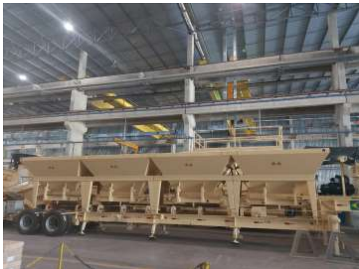
Usina de asfalto Voyager após finalização da montagem na fábrica
