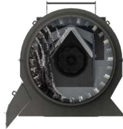
Adição do cimento asfáltico
