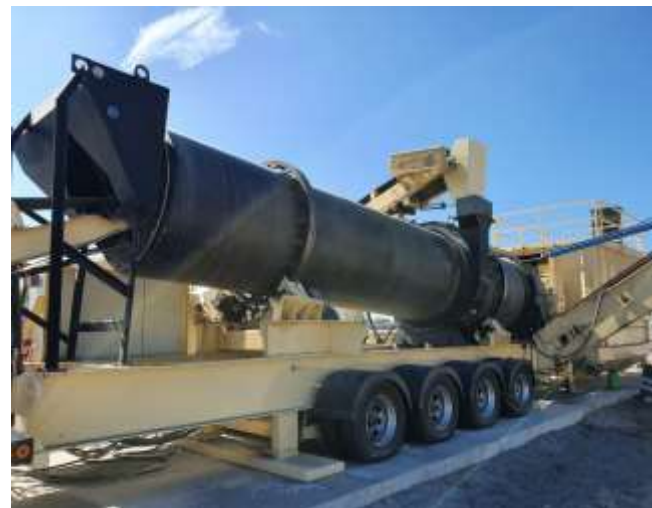
Entrada do RAP no tambor, em posição localizada após a passagem da chama do queimador
