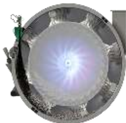
2. Entrada do asfalto líquido (CAP)
