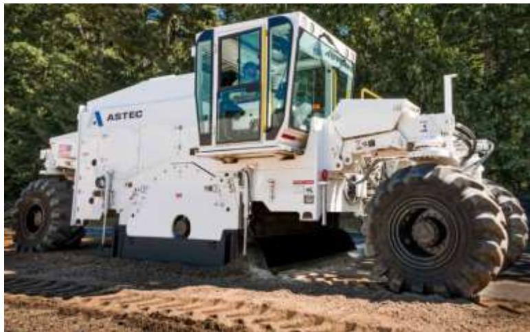
Estabilização de solos e camadas granulares de base
