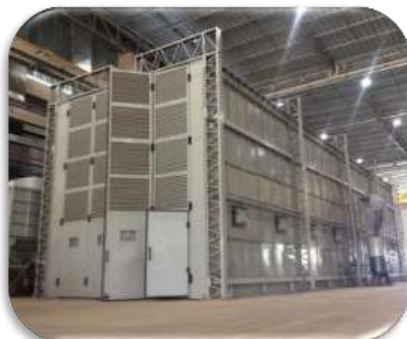
CABINE DE JATEAMENTO
